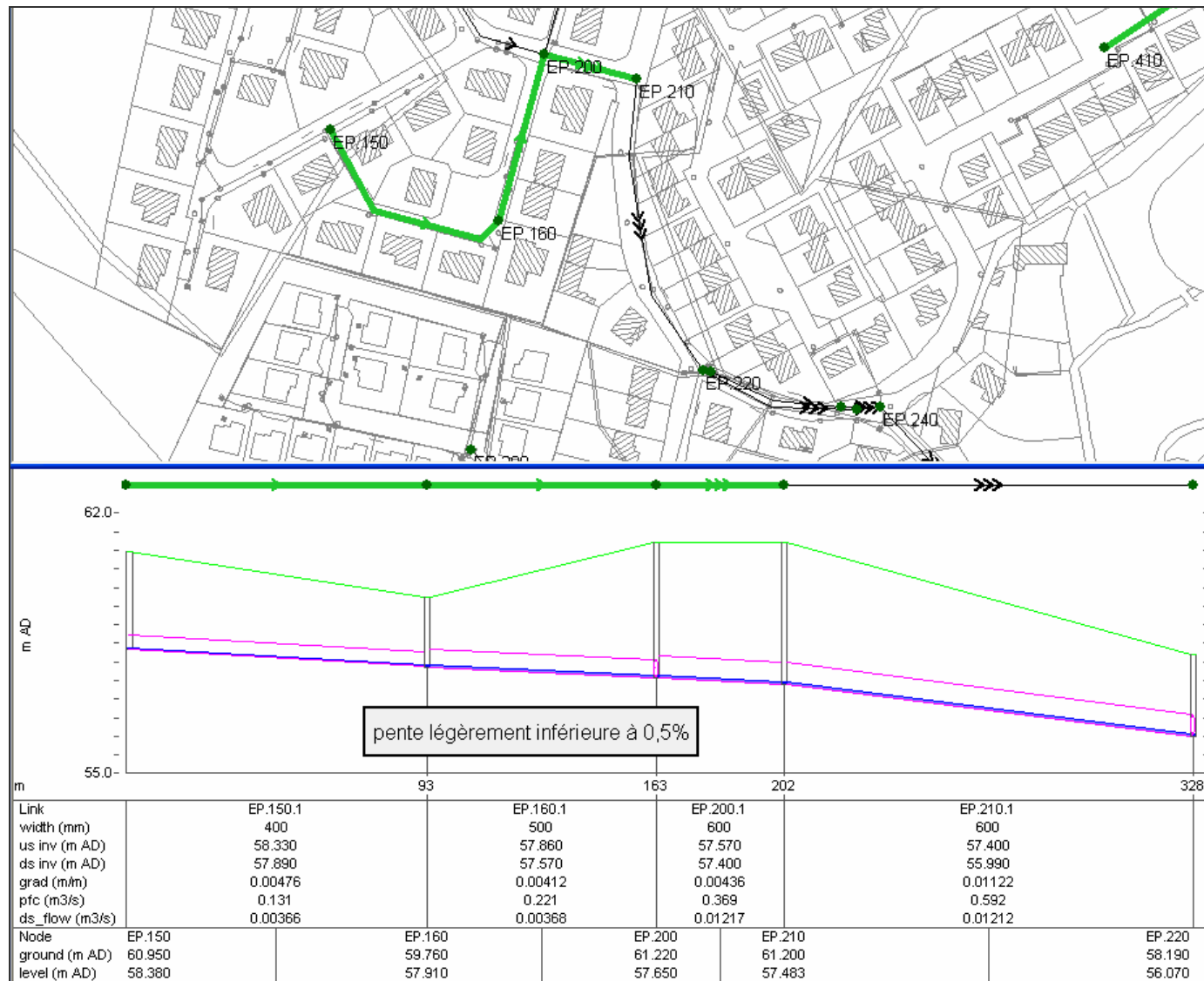
Figure 14 : Tronçons à faible pente : allée d'Orion
